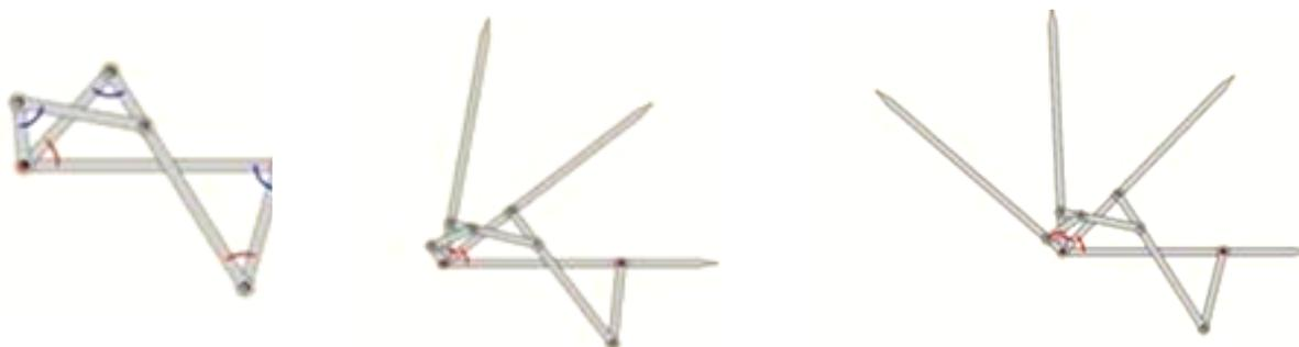
Вытягивая направляющие прямые, получаем плоский шарнирный механизм, который можно применять для построения биссектрисы угла. [Добавим еще один](#) подобный антипараллелограмм, угол при красном шарнире будет равен двум имеющимся. Получившийся шарнирный механизм называется *шарнирным трисектором* или *циркулем-трисектором*. Этот трисектор более сложен в изготовлении, здесь мне понадобилась помощь моего отца и я консультировался у своего научного руководителя
