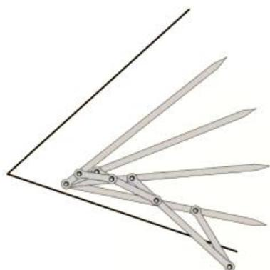
Для трисекции угла вершину данного трисектора совмещают с вершиной угла и с помощью рычага растягивают направляющие прямые, чтобы крайние направляющие совместились со сторонами угла, два других луча будут являться трисектрисами исходного угла.
