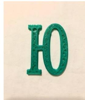
Я решила в ней работать, считаю ее наиболее простой для работы с 3D моделированием, первая программа более подошла для чертежей и сложных работ. Приступила к работе и освоению программы по началу было сложно, но я справилась. Первое, что я сделала, это был брелок с инициалом моего имени и при распечатывании у меня буквы получились не полностью, т.к. указала очень тонкие верхние и нижние границы.
